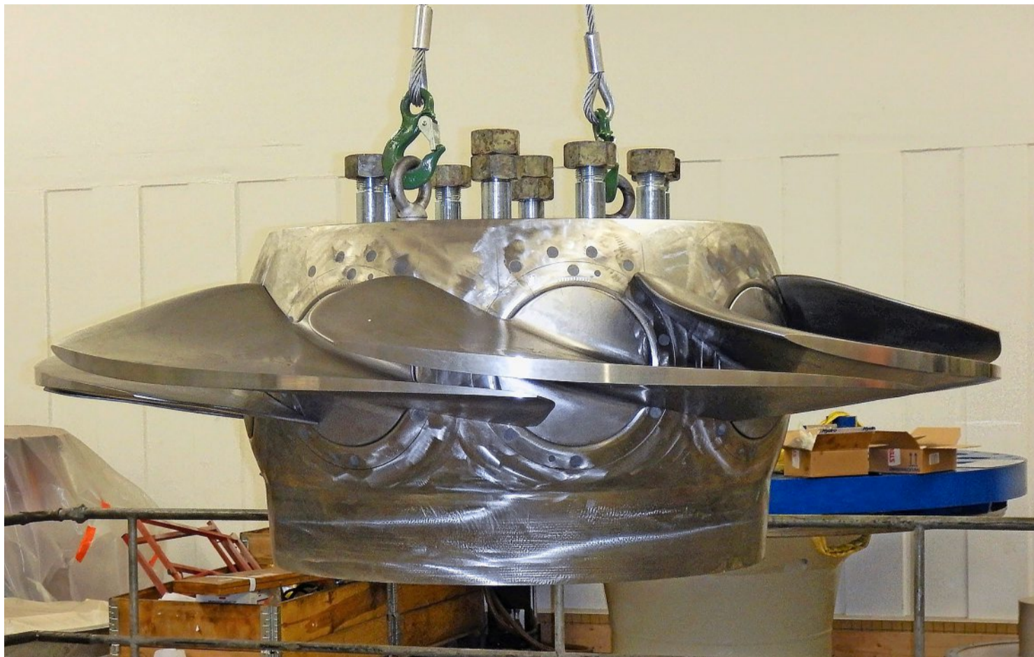
Das Laufrad der Kaplan turbine «verarbeitet» pro Sekunde 22 Tonnen Wasser. Foto: Guido Lauper
